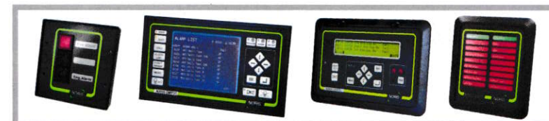
Система аварийно-предупредительной сигнализации с функциями контроля вахтенного механика
