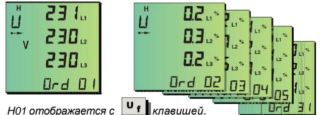
H01 отображается с Uf клавишей. H02...H31 прокрутки знач. с ▲ ▼ клавишами.
